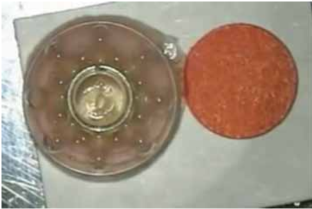
Şəkil.7 Titan sıxıcı halqa gövdənin qalan hissəsinə sıxılaraq bərkidildi.
