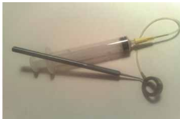
Рис. 4 Градуированное вакуумное кольцо (Calibrated Vacuum Ring)
